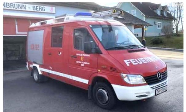
**Mercedes Sprinter**, BJ 2001, 156 PS, Hinterradantrieb, Besatzung 1+8
